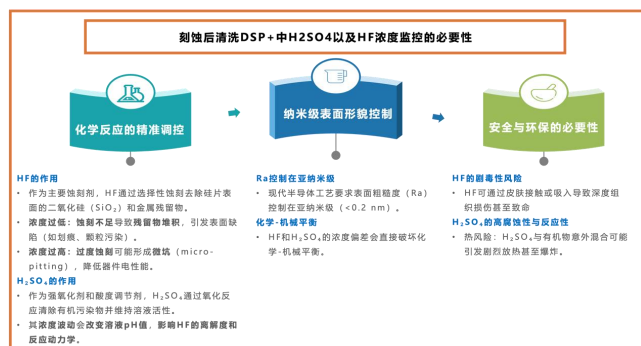
图 4. 刻蚀后清洗 DSP+中 \text{H}_2\text{SO}_4 以及 HF 浓度监控的必要性
