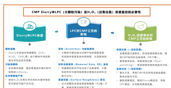
图 3. CMP Slurry 中 LPC 及 H_2O_2 浓度监控的必要性
