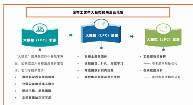
图 4. 涂布工艺中大颗粒的来源及危害
