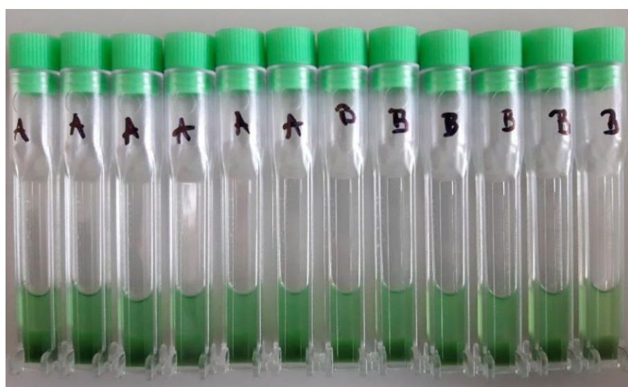
图 4.5 在 37° C 温度下样品 A 和 B 经加速离心后实物图
