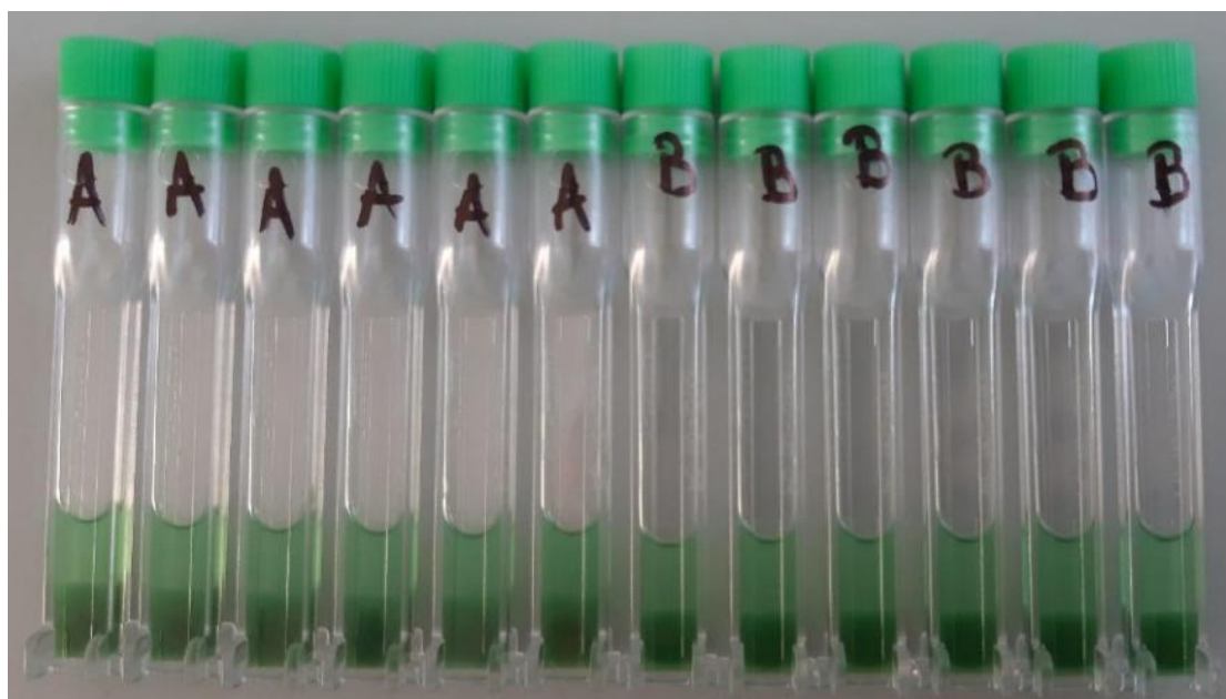
图 4.7 在 37°C 下样品 A 和 B 经 53 天老化后加速离心后实物图
