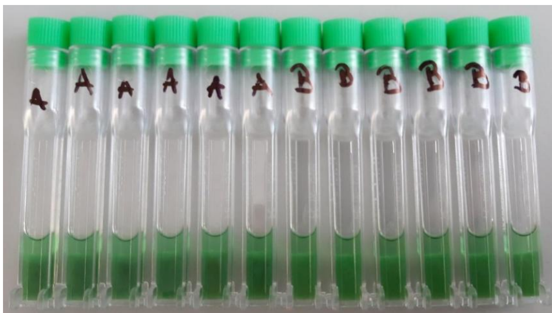
图 4.6 在 25°C 下样品 A 和 B 经 53 天老化后加速离心后实物图
