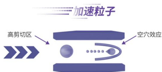
图 2.1 高压微射流工作原理
