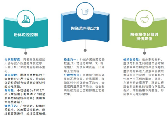
图4 MLCC陶瓷浆料制备关键点
