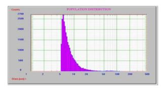
该软件还内置了通过/失败标准表,允许用户自定义32个通过/失败参数基于粒径大小和粒子数大于设置参数。下表基于USP788中小体积注射剂的10和25微米的标准。
