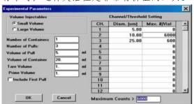
AccuSizer 提供两种客户界面模式,第一种是标准污染监测模式,最多 32 个用户定义通道,第二种是高分辨率颗粒尺寸模式,最多 512 个对数间隔通道。所有样品分析都以高分辨率模式和通道保存,可以关联到用户自定义的通道中。只需单击鼠标,客户就可以在两种模式之间切换,甚至可以更改用户定义的通道并重新计算结果,而无需重新运行样本。
